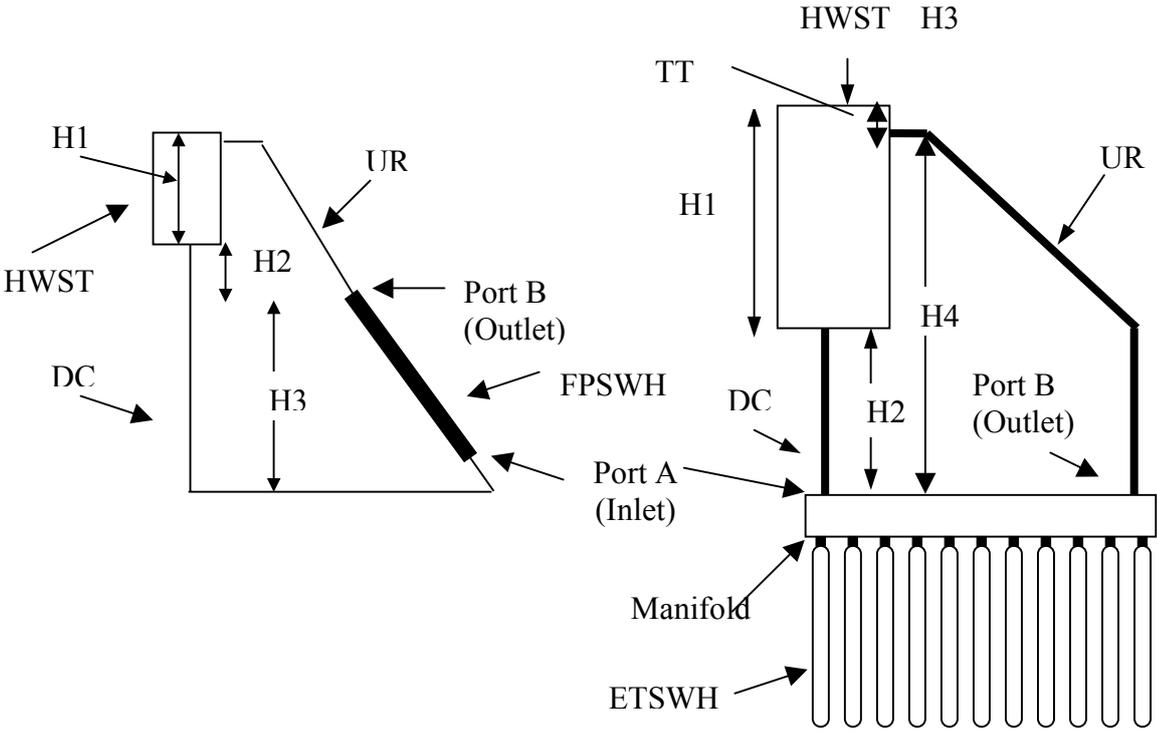
Fig. 2 Thermosyphon FPSWH
